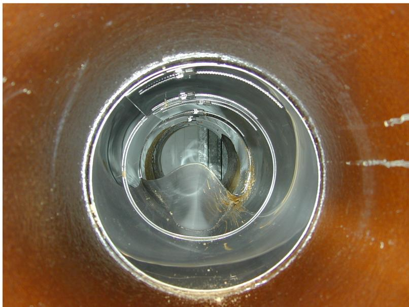
Bild 7 Stabilitätsversagen der Manschette DN 300
