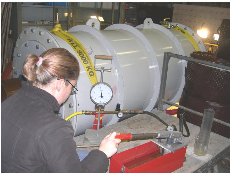
Bild 5 Druckbeaufschlagung der Quick-Lock-Manschetten im Labor für Baustoffe [2]
