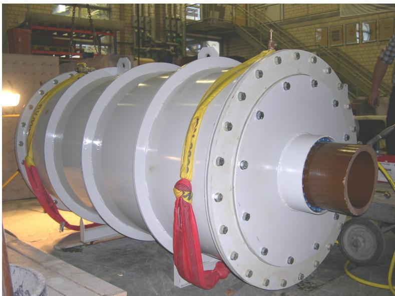
Bild 2 Druckkammer
