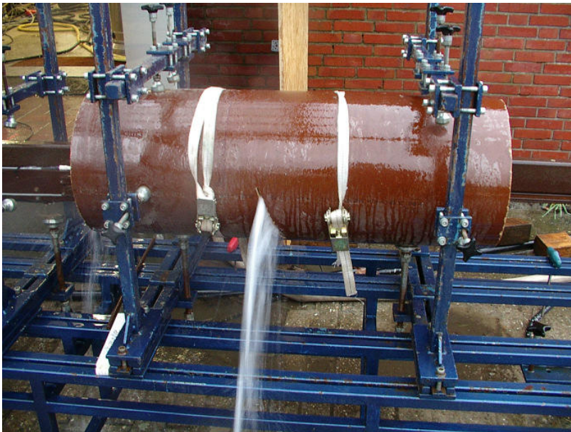
Abbildung 5: Prüfstück mit Standard-Manschette im Versuchsstand
