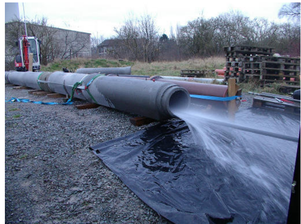
Abbildung 7: Praxisprüfung am Quick-Lock-System / Beton-Rohr (Außenaufnahme)
