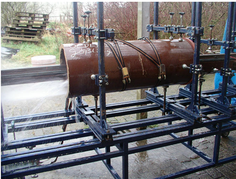
Abbildung 8: Prüfstück mit aufgebördelter Manschette im Versuchsstand
