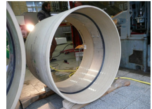
Bild 4: Fertig installierte Manschetten
