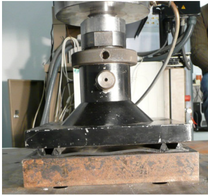
Bild 5: Druckprüfung an der EPDM-Dichtung
